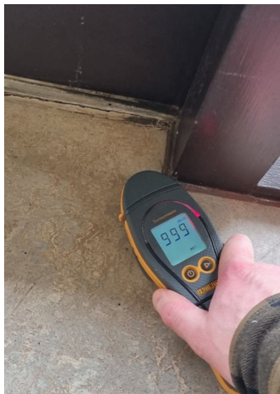
MYND 10 Hækkaður raki undir dúk við inngangshurð, vegna ófullnægjandi þéttinga milli timburs og steins.
