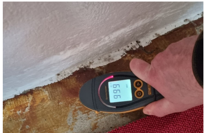
MYND 4 Hækkaður raki í botnplötu í kjallari undir samkomusal.
