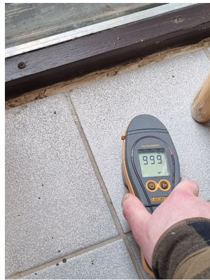
MYND 11 Hækkaður raki undir flísun við gólfsíðan glugga, vegna ófullnægjandi þéttinga glugga milli timburs og steins.
